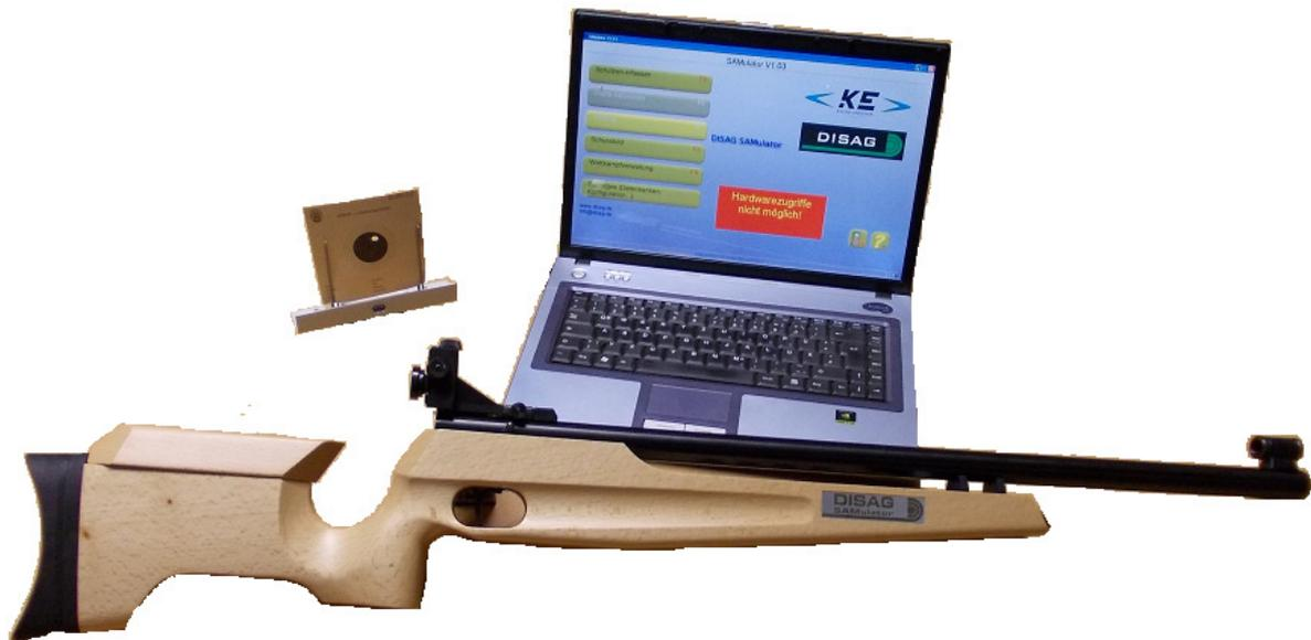
Bei dem sogenannten Lichtpunkt oder Simulationsschießen wird elektronisch ein realer Schuss simuliert. Das Lichtpunktgewehr sendet einen unsichtbaren Lichtstrahl (Laserstrahl) zum Ziel und markiert den Schusstreffer mit einem roten Punkt. Das Trefferergebnis wird auf einen Bildschirm zum Schützen übertragen.
